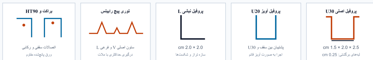
شکل ۱: مقاطع مهندسی پروفیل‌ها، هندسه ستون‌های توری و قطعات اتصال اختصاصی پیچ رابیتس
