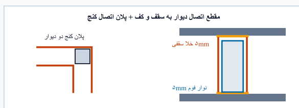
شکل ۶: جزئیات اتصال دیوار جداکننده به کف، سقف و کنج (راست) و سه روش افزایش طول استاد (چپ)
